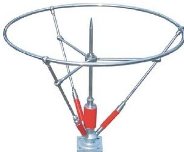
凯威®可控放电避雷针主要由主针、动态环、水平拉杆、斜杆、储能元件、接地元件等组成。相比老式避雷针具有针护范围大、绕击率低、放电电流小、感应过电压低等优点，雷雨天气必要时可迅速形成放电脉冲，能切实有效缓解输电线路雷击跳闸问题。
